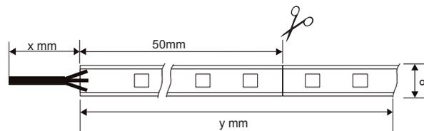
x: Einspeiseleitungslänge/feeding cable length
