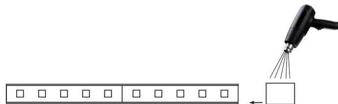
Nach dem Ablängen muss die so entstandene Anschlussstelle mit Schrumpfschlauch dicht ummantelt werden. Andernfalls erlischt die Garantie.
