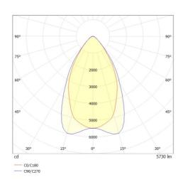
I valori indicati sono nominali. Tolleranza della potenza e del flusso luminoso +/- 10%. Tolleranza della temperatura colore: +/- 150 K. I valori sono riferiti ad una temperatura ambiente di 25°C, salvo diversa indicazione.
